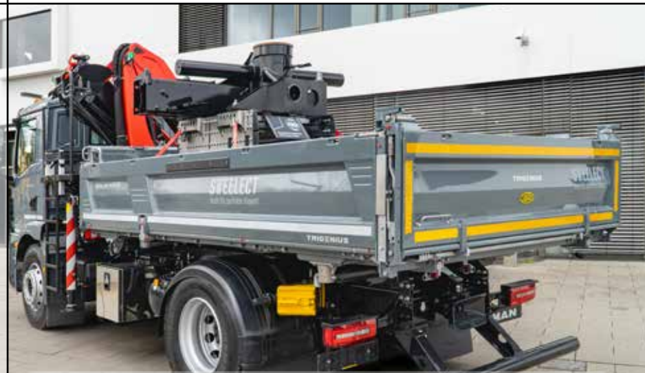
Meiller Kipper pokazał serię wywrotek trójstronnych TRIGENIUS i swoją opatentowaną koncepcję montażu żurawia, wyłącznie za pomocą połączeń śrubowych
